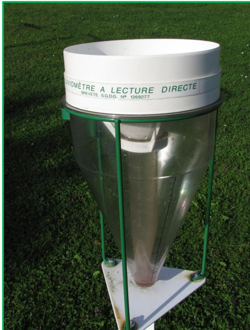
En cas de neige, le cône sommital est retiré, la neige se dépose alors dans le grand récipient avant d'être fondue à la température ambiante d'une pièce intérieure. On mesure ensuite la quantité d'eau obtenue de la même manière que pour la pluie.
